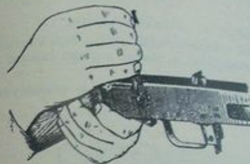
74. ábra. A tűzváltó leszerelése a tokról.
