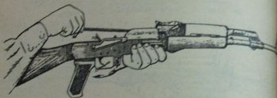
72. ábra. A tokfedél ráhelyezése a tokra.
