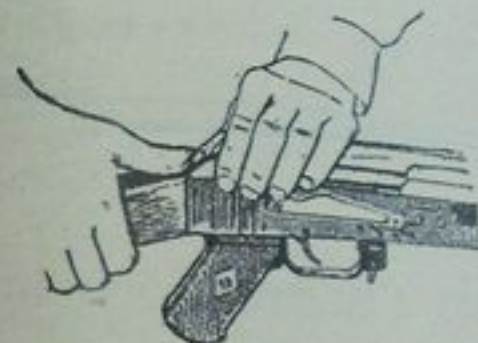
66. ábra. A tokfedél levétele a tokról.
