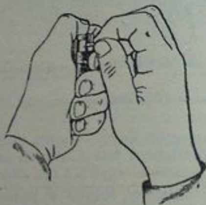
79. ábra. A hüvelyvonótengely behelyezése a zárba.
