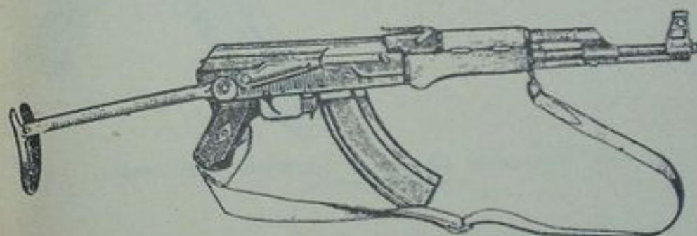
1. ábra. Kalasnyikov géppisztoly: felső — fatusával; alsó — behajtható váltómasszal.
