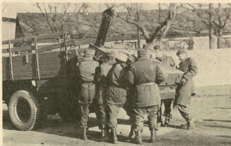
76. ábra. Lemálházott felépítmény felrakása gépkocsiplatóra
